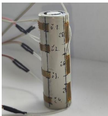
Obrázok 3.3: Umiestnenie tenzometrov na povrchu článku Molicel INR21700-P45B na účel určenia vhodnej polohy na meranie povrchovej deformácie.
